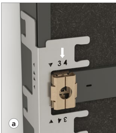
Platzierung der Montagehilfe am Abschlussprofil und Befestigung des ersten Montageclips am Querprofil. Dieser Vorgang wird auf der gegenüberliegenden Seite wiederholt.
